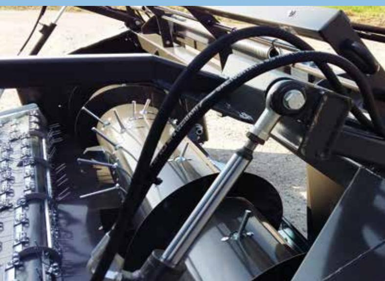
La coclea è di grande dimensione ed è completa di dita retrattili e regolabili per il corretto adattamento alla tipologia del materiale da raccogliere.
