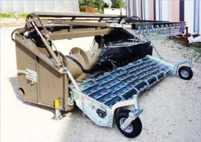
Il pick up può essere completato con uno schiaccia fieno con sistema idraulico per regolare la posizione e dosare il materiale.
