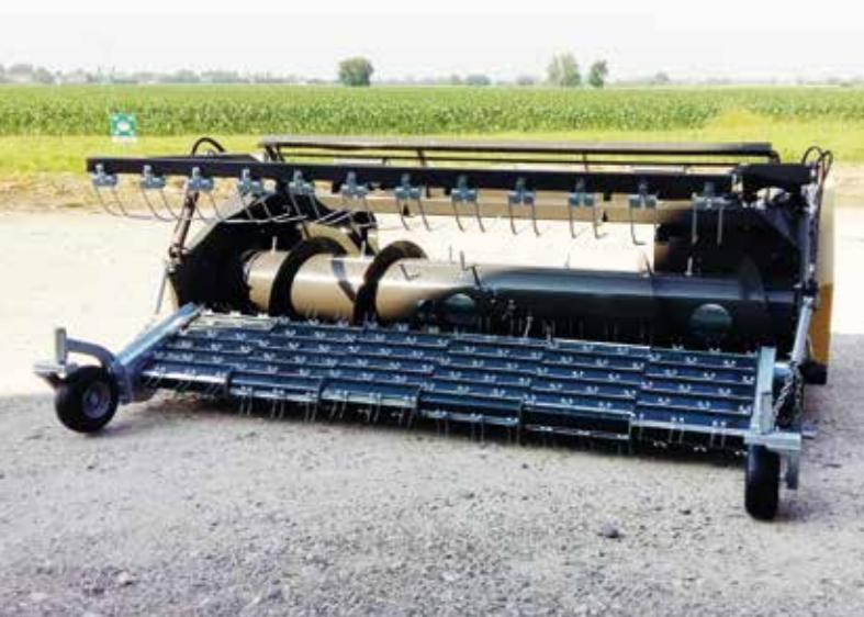
Le ruote frontali pivotanti sono regolabili e del tipo a gomma piena.
