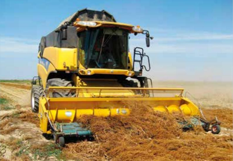
La trasmissione principale è ottenuta dal cardano, la trasmissione del tappeto si può ottenere con l'utilizzo del multifaster oppure installando un impianto autonomo con pompa e serbatoio collegati al cardano.
